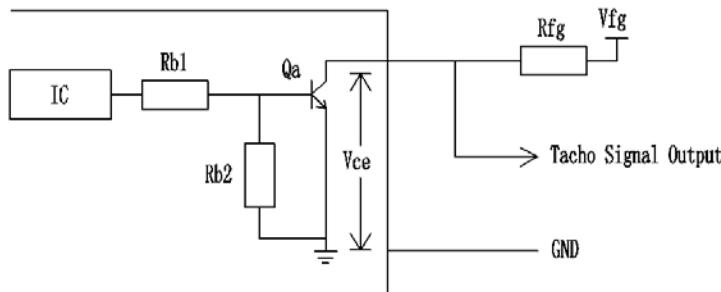
当风机待机时, 速度反馈输出低电平; 当风机故障时, 速度反馈输出高电平; 当风机运转时, 速度反馈输出占空比为50% 的方波, 频率与电机输入电流的频率一致, 根据公式 $n = 60f/p$ , 其中n为转速, f为电机输入电流的频率, p为极对数。本型号电机的极对数为5, 每转输出5个方波。
