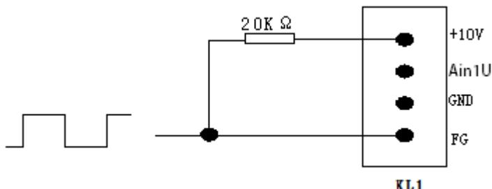
FG 信号电路的外接电源, 需要保证稳定性, 不允许输入超过规格的电源电压, 电源无明显的尖峰与浪涌冲击。外接电阻选型需要符合规格书要求。FG 端口需要注意防静电损伤。
